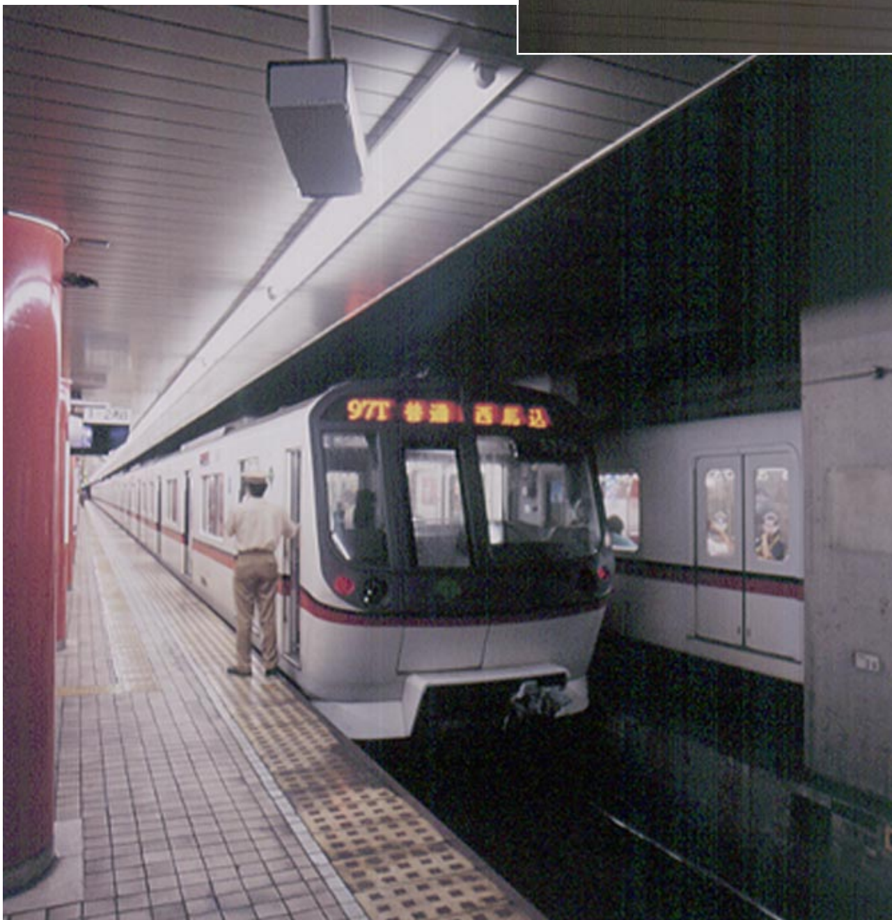
電車が駅に到着すると、センサーが編成を検知して、6連・8連用いずれかのカメラが作動します
