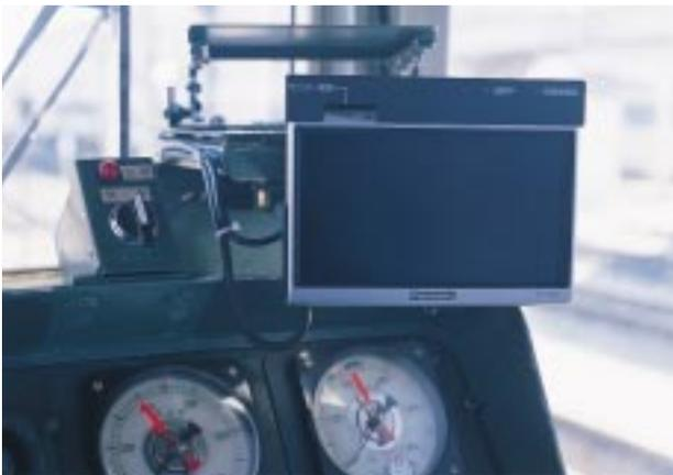
走行時の振動や衝撃に耐えられるように電源供給や映像信号変換機能をディスプレイコントロールユニットと分離して設置
