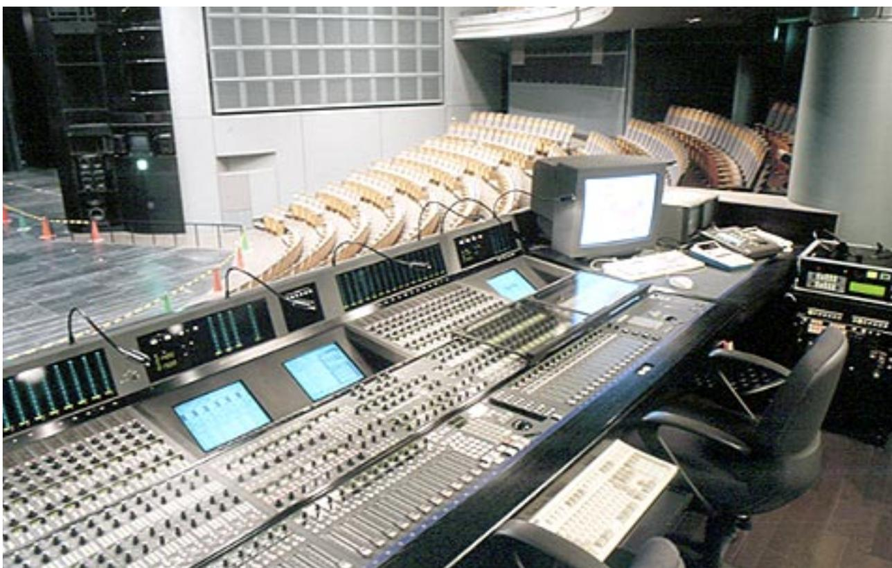
アナログ卓の操作感覚を継承しながら、CRT画面による情報表示で操作性を向上させたフルデジタルミキサー
