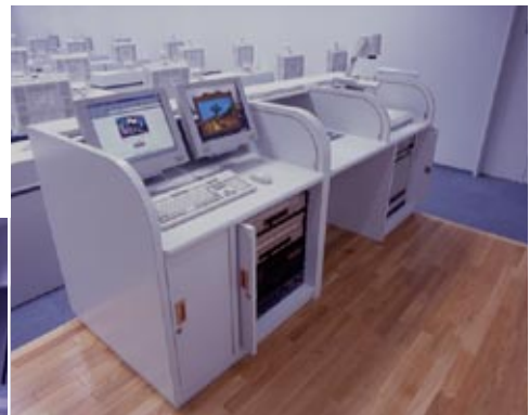
教師用マスター卓。視聴覚機器の操作を一括しておこなえます
